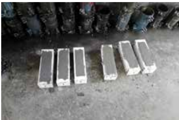
▲ 製作混凝土試驗模型（圖左），以檢視有無收縮狀況發生。
