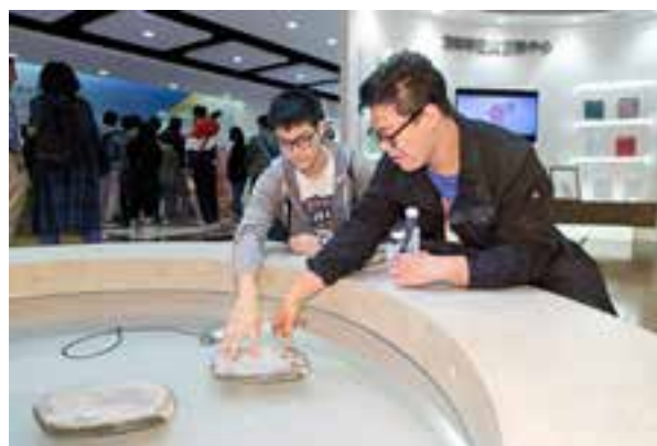
▲ 同學們可親手拿取、觸摸不同的混凝土磚，認識鋪在人行道防止積滄水的「透水混凝土」，以及常用於輕隔間建材、可浮在水上的「浮水混凝土」。
