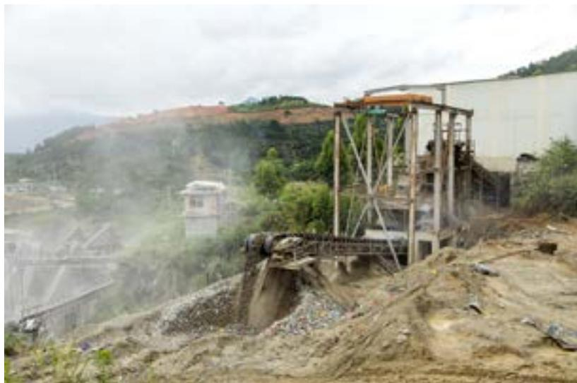
▲步驟 4：二破。透過二破的圓錐機再把石塊打碎。
