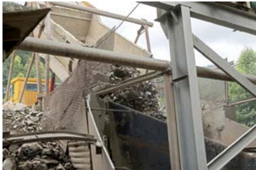
▲步驟 3：大破。由傾卸車卸載下來直徑約在 60 ~ 80 公分的石塊，倒入顎碎機進行大破工程，約 4 分鐘即可消化一車約 37 噸的石塊原料。
