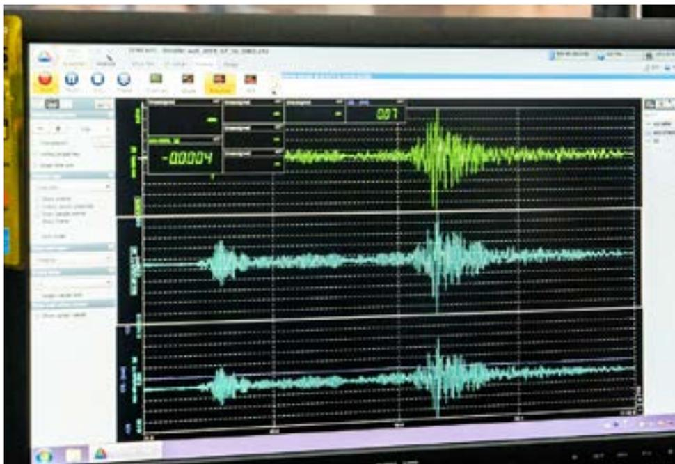
▲操控室儀器可設定各種震波模擬。
