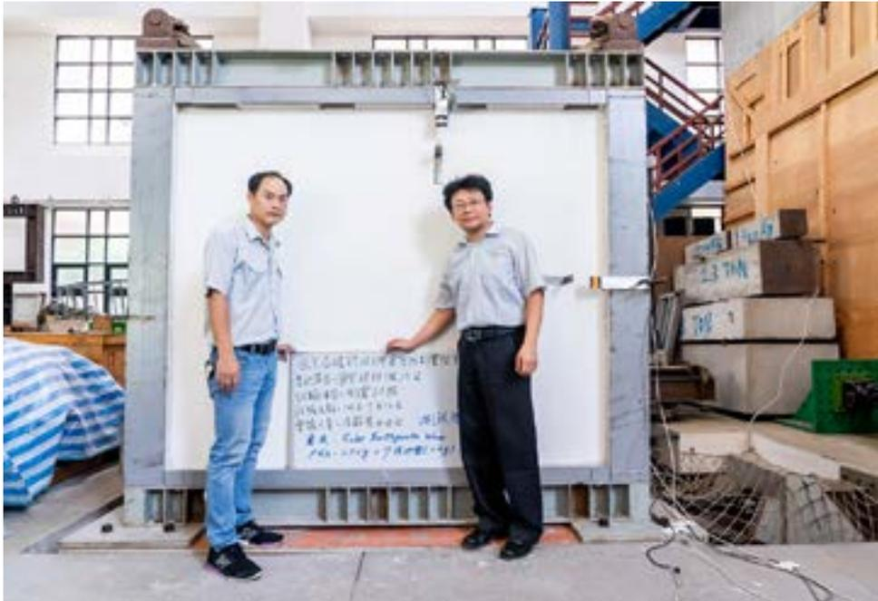
▲ ALC 輕質磚經過日本阪神大地震的模擬測試，測試結果為  $PGA = 0.72g > 7$  級地震 ( $0.4g$ )，證實它具有超越 7 級以上的耐震實力。
