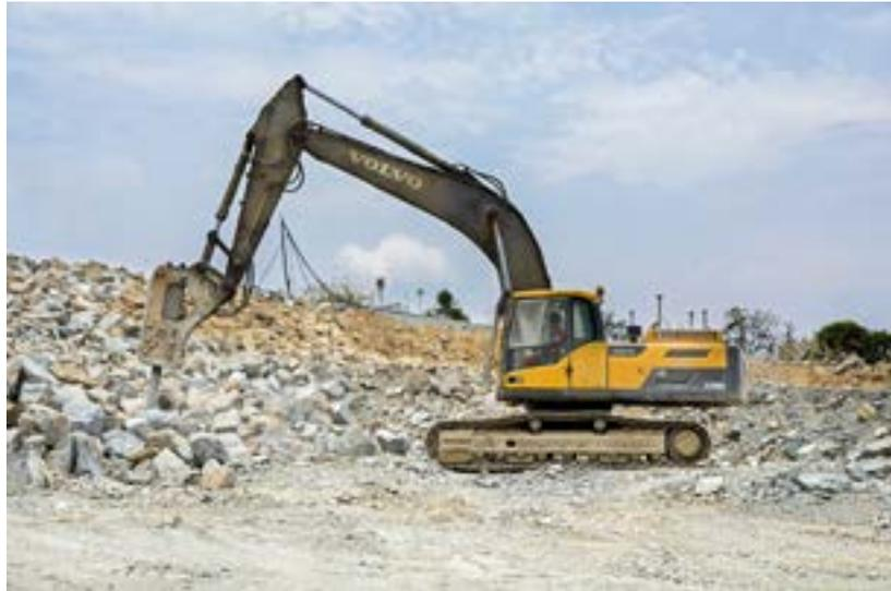
▲步驟 2：破碎槌分解。爆破完的石塊直徑長達 1、200 公分，再經破碎槌進行兩次分解作業，打成直徑小於 80 公分的石塊。
