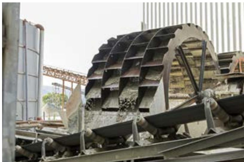
▲步驟 7：水洗。將 7mm 以下的石粉，運載至閩江邊製砂基地進行研磨、整型、水洗製程，降低含泥量，成為 4 ~ 0.15mm 的機製砂。
