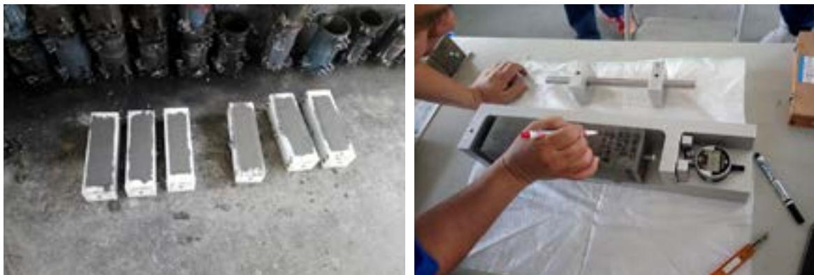
▲製作混凝土試驗模型（圖左），以檢視有無收縮狀況發生。
