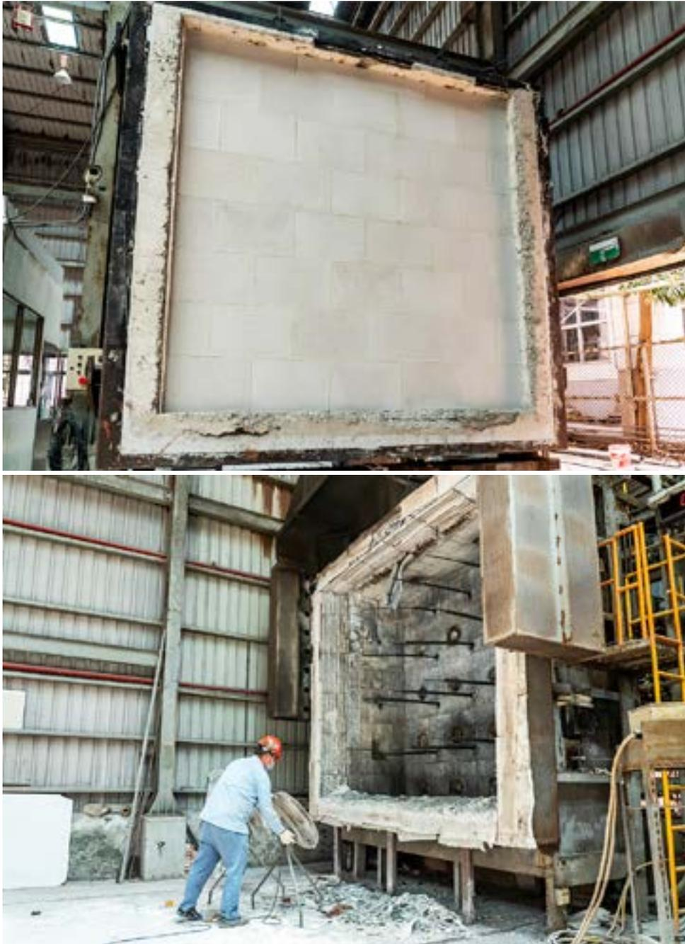
▲無論是 10cm 或 15cm 的輕質磚，經過連續 2 小時、達 1,000°C 高溫的防火測試後，表面皆完好如初，耐火測試爐則被大火燻黑、佈滿灰燼。
