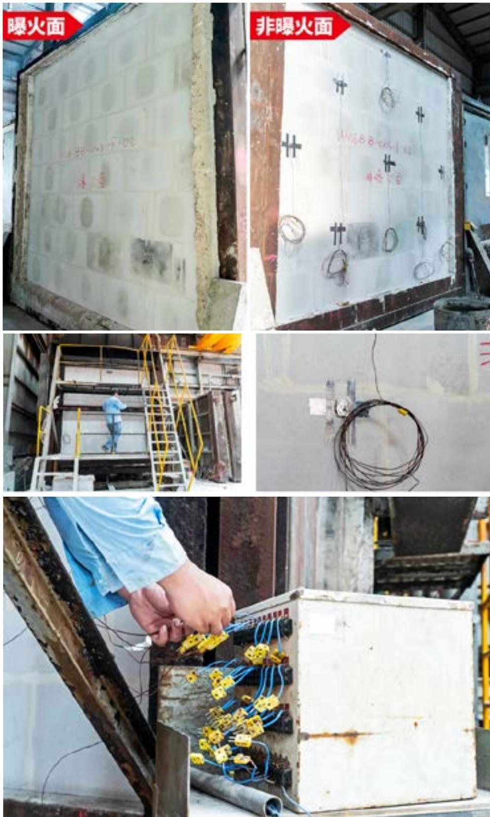
稍微簡單說明一下，輕質磚隔熱阻燃的標準：非曝火面的平均溫度須小於室溫 +140 度，高溫須小於室溫 +180 度。若舉這次實驗的 10cm 隔間牆為例，測試時的初始室溫為 27.8°C，因此經過 2 小時、1,000°C 高溫測試後，均溫須小於  $27.8+140=167.8^{\circ}\text{C}$ ，高溫則得小於  $27.8+180=207.8^{\circ}\text{C}$ ；同理可證，若再以 15cm 隔戶牆來說，實驗的初始室溫為 30.4°C，均溫與高溫上限分別是 170.4°C 和 210.4°C。
