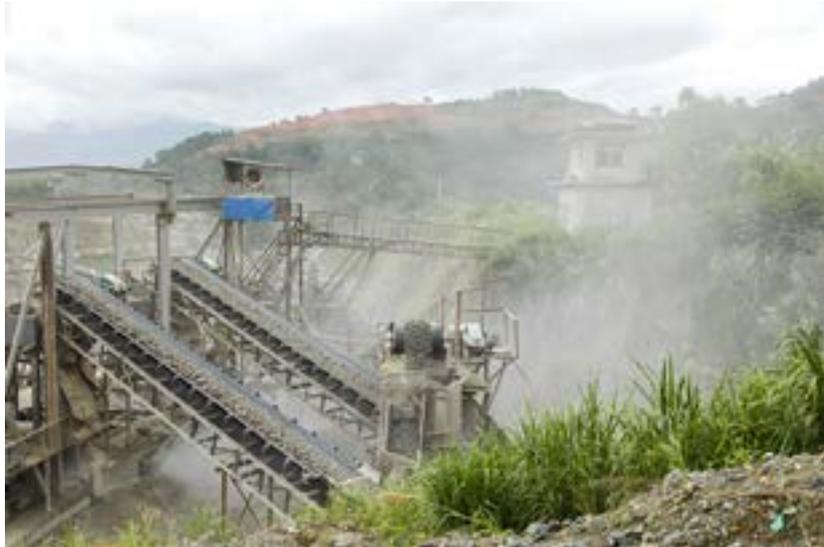
▲步驟 5：三破。經過三破圓錐機碎解研磨整型後，石塊大約小於 28mm。
