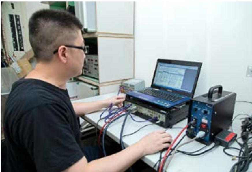
分析圖表顯示，10cm 與 12cm 隔間牆的隔音量分別是 Rw45 分貝和 Rw50 分貝，15cm 隔戶牆的隔音量則為 Rw52 分貝，均符合建築法規的隔音指標，不僅可運用在集合住宅，保障居家安寧，只要控制好空調噪音，在家更能享受高規格的視聽設備。
