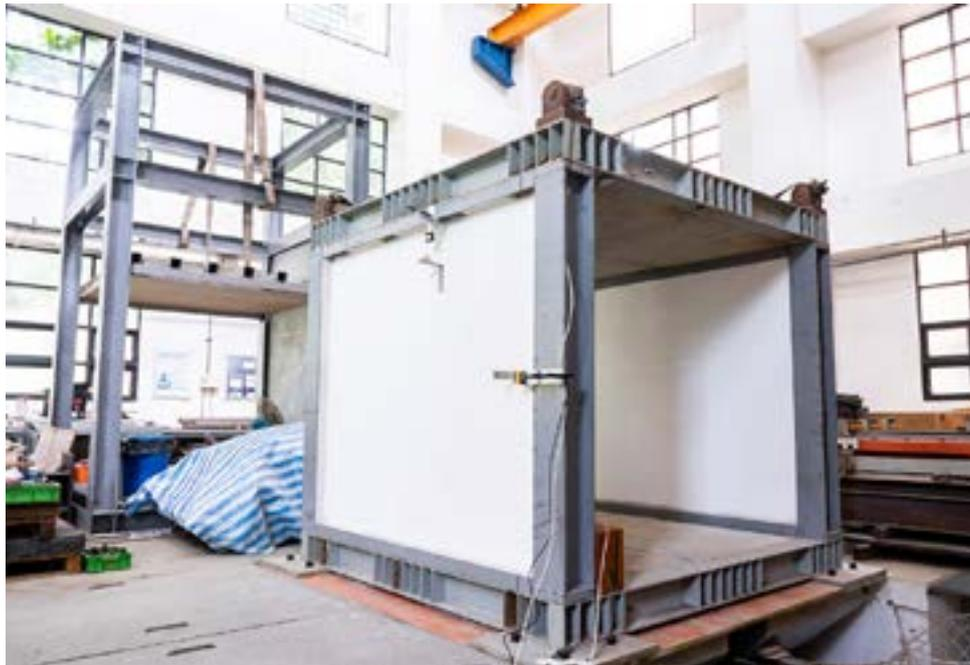
▲現場模擬有四根樑柱與樓板的鋼構房子，在兩側裝上 2m×2m×10cm 的輕質隔間牆。
